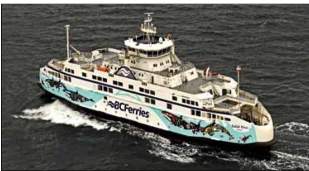
Salish Ora – jeden z trzech nowoczesnych promów pasażersko-samochodowych napędzanych silnikami zasilanymi LNG, zbudowanych w stoczni Remontowa Shipbuilding. Promy zostały zbudowane dla BC Ferries – największego w Ameryce Północnej, kanadyjskiego operatora promowego.
