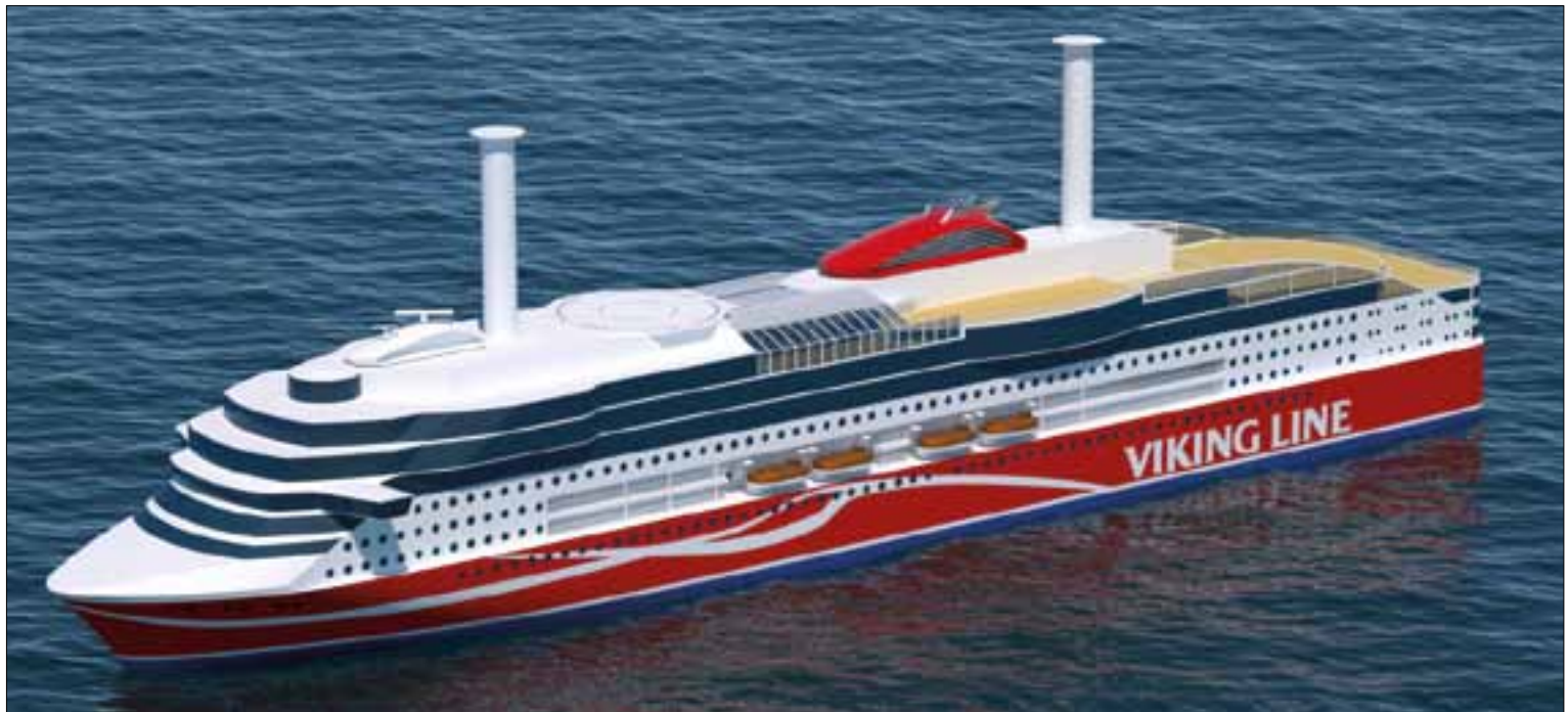
Projektowany przez Deltamarin, m.in. w Gdańsku, prom o pojemności brutto ok. 63 000 jedn. z rozbudowaną częścią pasażerską (tzw. cruise ferry) i pomocniczym napędem w postaci rotorów Flettnera, który do roku 2020 ma zbudować dla Viking Line chińska stocznia Xiamen Shipbuilding Industry Co. Rys.: Viking Line
